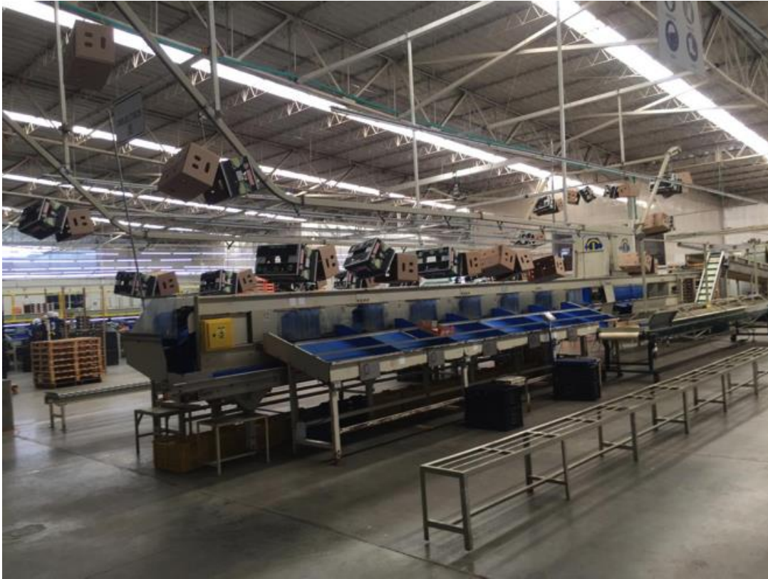
Ilustración 7: Línea de selección. Cajas vía área para evitar contaminación de plagas
