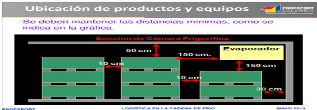
La siguiente imagen muestra a qué distancia deberían estar los evaporadores, que son los equipos que regulan la temperatura del cuarto frío ya que son los encargados de expulsar el aire para que esto suceda. (Ver imagen 1.2)
