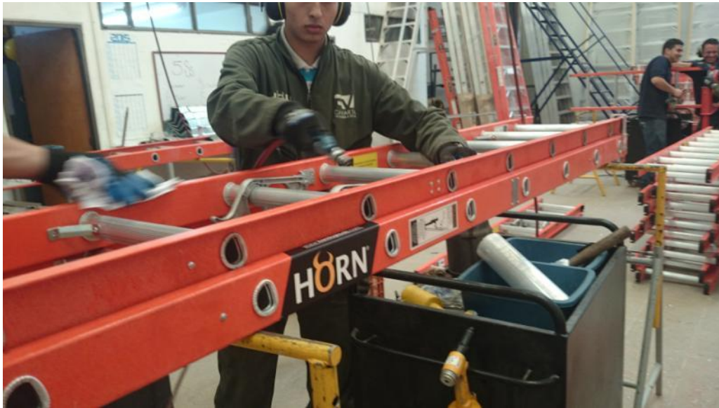
Figura 21 proceso de ensamblaje de escaleras en Cavar
