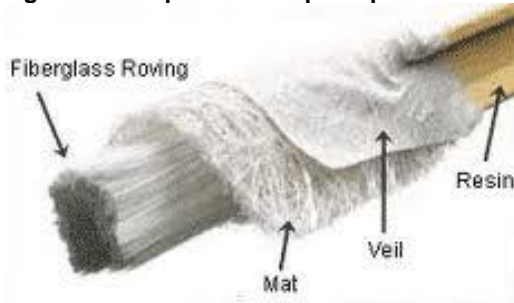
Figura 36 composición de perfil pultruido
