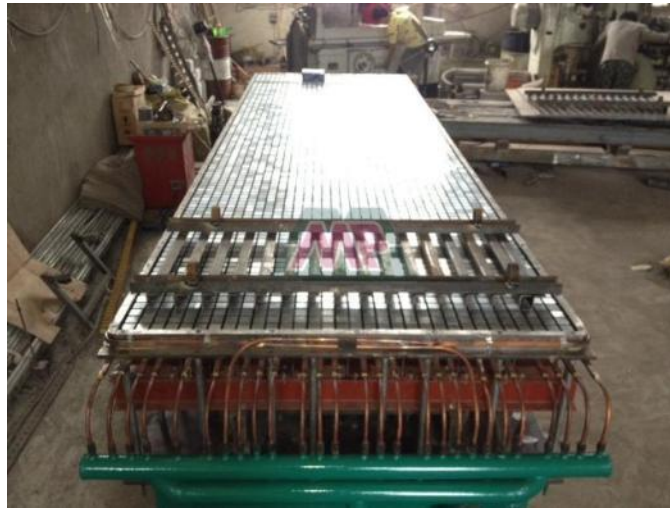
Figura 42 Maquinaria de moldeo de rejillas
