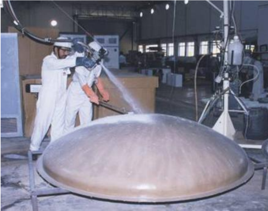
Figura 14 Imagen de proceso de "Spray Up"
