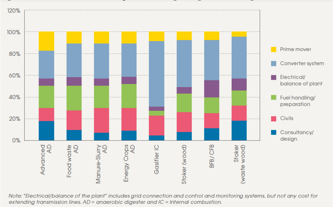
Figura 24. Estructura de costos de capital en tecnologías de generación energética con biomasa
