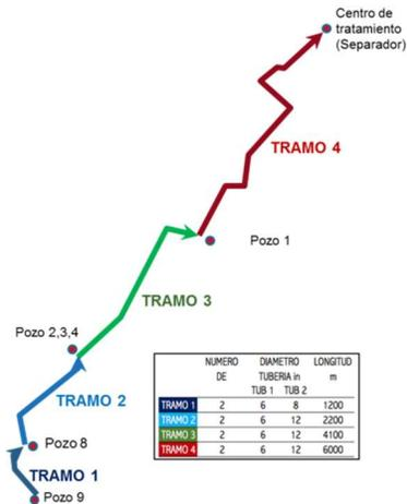
**Ilustración 4 distribución de pozos y tubería**
